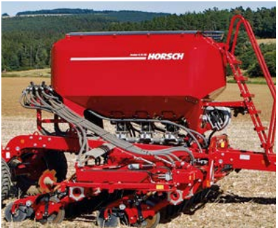
Triple hopper 3 800 litre, partition 60 : 10 : 30
