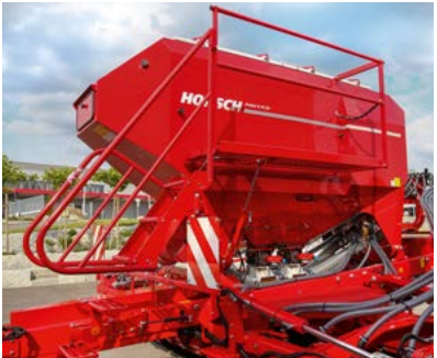
Double hopper 5 000 litre; partition 40 : 60
