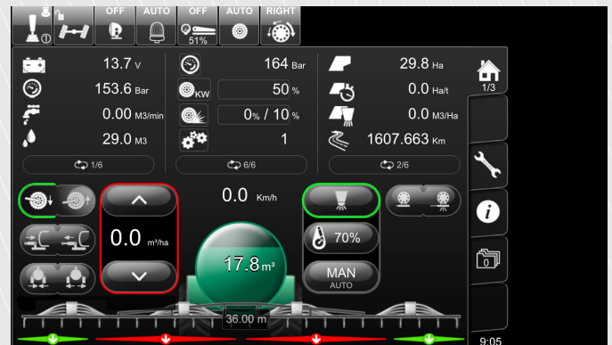
Det er meget nemt at betjene den nye bom via SlurryMaster8000 styresystemet. Man kan også se, hvilke fordelere, der er i brug.
